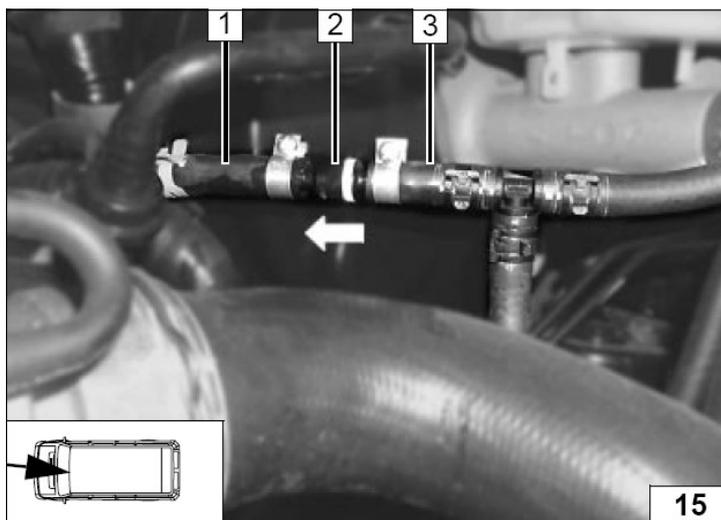
Установка клапана на а.м. без тройника
