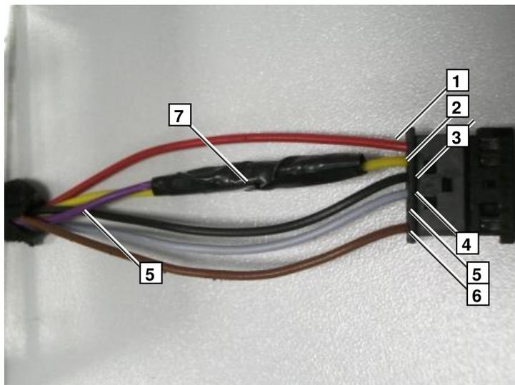
подсоединить 4х контактный разъём жгута телестарта ид № 9010951А к ответному штекеру жгута комплекта переоборудования.
